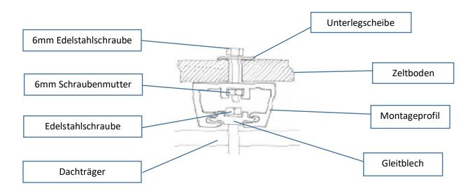
Legen Sie die Montageprofile so in Position, dass die Löcher des Profils und des Zeltes übereinander liegen. Legen Sie an den entsprechenden Positionen eine 6mm Mutter in das Montageprofil. Die 6mm-Schrauben müssen von innen durch die vorgebohrten Löcher im Zeltboden gesteckt werden. Versehen Sie die Schrauben vorher mit den passenden Unterlegscheiben. Befestigen Sie die Montageschienen, indem Sie die Schrauben von der Innenseite des Zeltes aus in die Muttern eindrehen.
